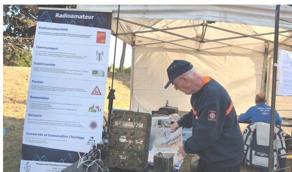
Didier F4GJM prépare son ANGRC9, Communément appelé C9, alimenté par la fameuse « gégène » et un bon « pédalage » des bras
