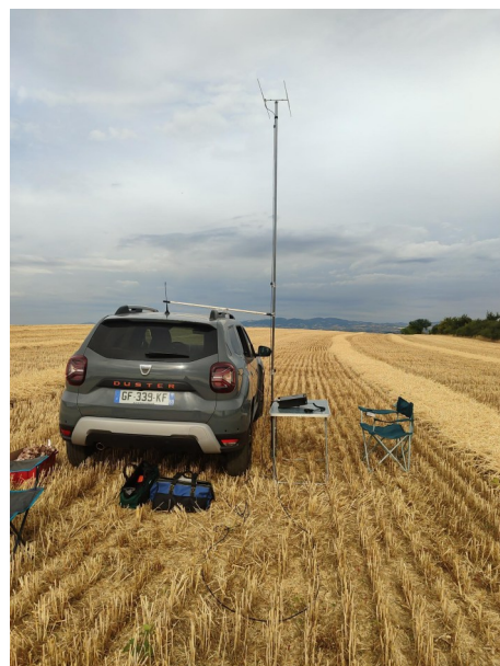
Installation du mat fixé au sol et sur la galerie
